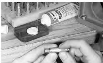
Matrizes com *carbide* não necessitam de lubrificante.
