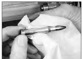
**5 AO SE CARREGAR** cargas máximas, é melhor remover qualquer lubrificante residual com água e detergente. Isso reduz a pressão contra o parafuso.
