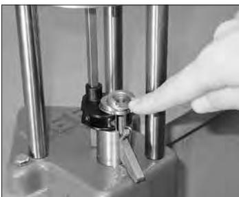
**A** Encaixe o shell holder no devido lugar. Certifique-se de que o braço espoletador fique entre as elevações na base. O fim do pistão pode ser rotacionado para propiamente se alinhar o braço à base. Esse alinhamento é crucial para o espoletamento correto e a indexação da torre. Instale e ajuste as matrizes de acordo com as intruções dos fabricantes.
