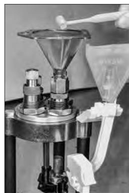
**3 ABRA A BOCA DO ESTOJO** para facilitar a instalação do projétil. Levante o pistão para expandir o pescoço do estojo. Para aumentar a abertura, aparafuse mais o die. Sempre ajuste para abrir o mínimo necessário para assentar o projétil. Após o ajuste correto, aperte o anel de travamento.
