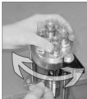
**B** Opere a prensa para cima e para baixo, realizando um ciclo. Se a torre não parar na posição correta, siga essas instruções: Com o eixo na posição mais baixa, coloque uma chave inglesa de 11mm na haste de indexação e segure-a em posição – agora, gire a torre para a posição correta.
